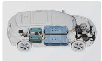
電気自動車搭載の二次電池
